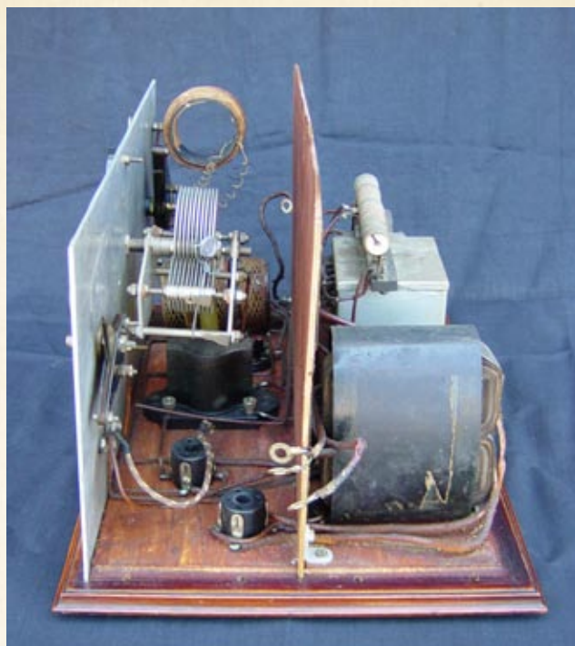
Sopra a sinistra: particolare della piombatura del fil di ferro attorno al condensatore variabile.
